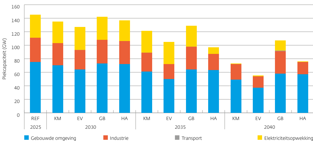
FIGUUR 2.6: PIEKCAPACITEIT ONTWIKKELING BINNENLANDSE GASVRAAG IP2026-SCENARIO'S
